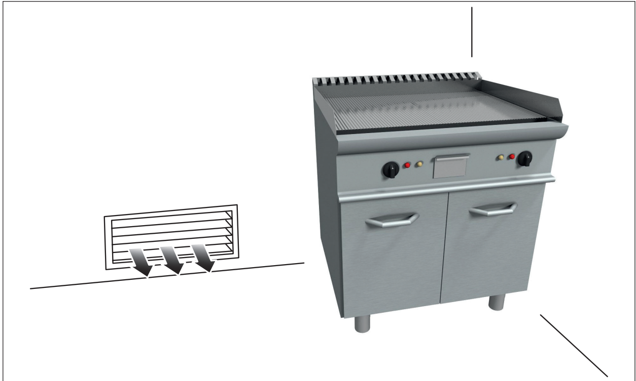
Abb. 20 Belüftung des Installationsraums
