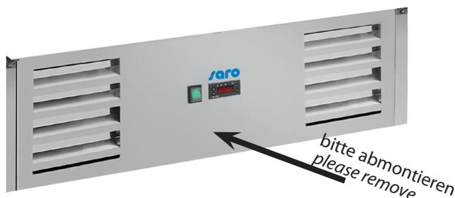
Demontieren Sie die untere Sockelleiste mit einem Kreuzschlitzschraubendreher (4 Schrauben). Achten Sie bei der Demontage der Frontblende auf die Kabel der Elektronik. Nicht zu stark ziehen, Kabel ist mit Blende verbunden.
